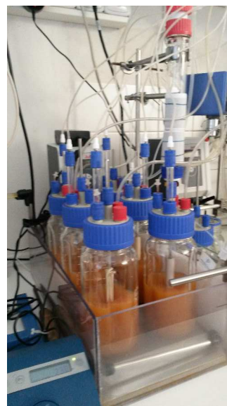
Obr. 5. Laboratórne testy chemickej a bakteriálnej oxidácie železa v banskej vode s on-line analýzou plynov, pH a ORP.
